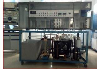
• 制冷系统性能测试台
